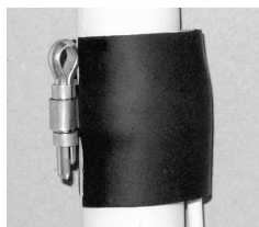
Izolační čidlo s termoizolační páskou
