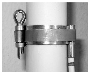
Teplotní čidlo s kontaktní páskou
